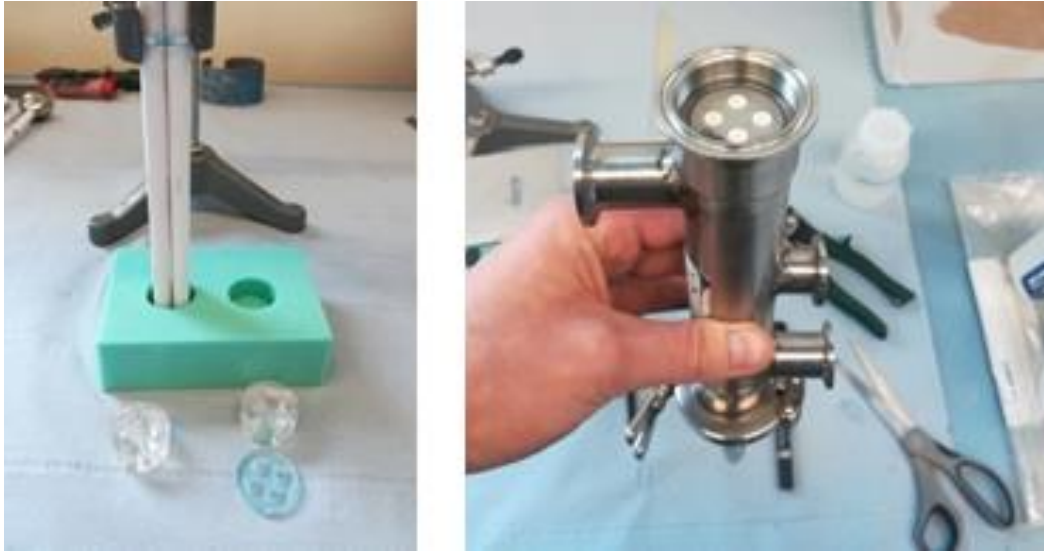
Abbildung 17: Herstellung keramisches Rohrmodul aus vier Monokanälen (Membrangeometrie 2 6/10)
