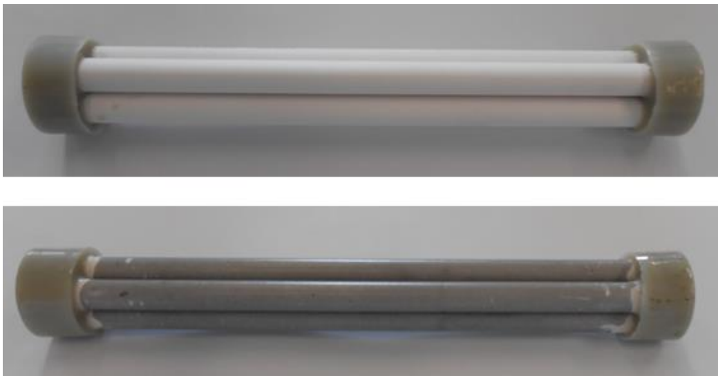
Abbildung 21: Keramikmembranen vor- und nach der Filtration in einer GAK Epibon A 8x40 Rohrmodul-Adsorptions-Kombinationseinheit, oben unbenutzte Membran, unten Membran nach Langzeitversuch
