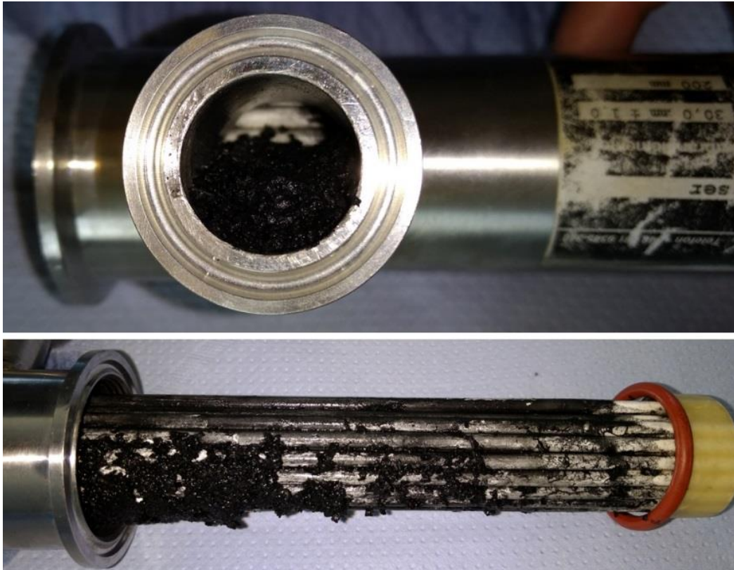
Abbildung 16 mit Aktivkohle (1-3 mm) gefülltes keramisches Rohrmodul (Membrangeometrie 1 3/6)
