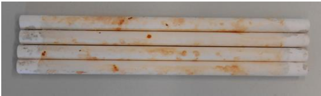
Abbildung 25: Keramikmembranen nach erfolgter thermischer Behandlung bei 550 °C
