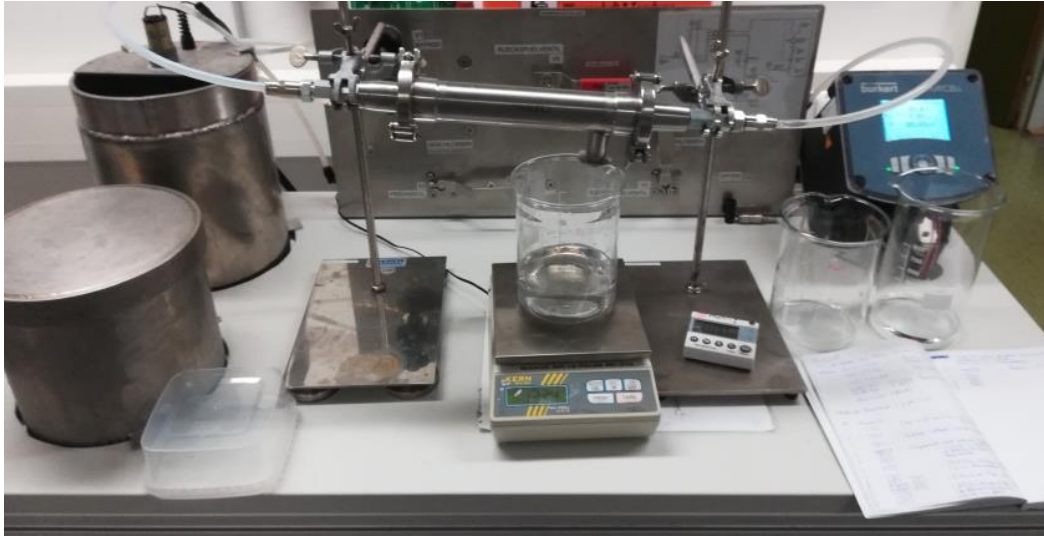
Abbildung 19: Versuchsaufbau zur Leistungscharakterisierung der Rohrmodul-Adsorptions-Kombination
