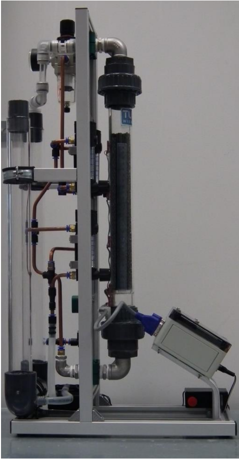
Abbildung 57: Meßanordnung für Schüttungsdruckverluste bei Durchströmung (TUW ICEBE)
