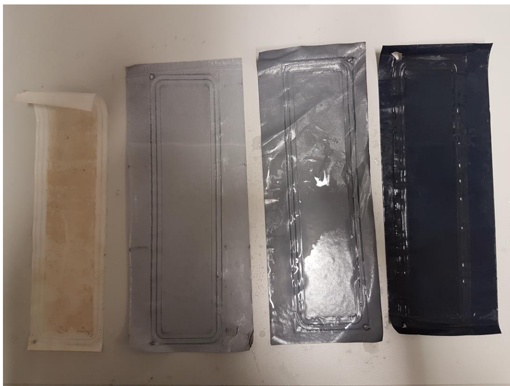
Abbildung 72: Getestete Embedded-Flachmembranen mit 0 m%, 5 m%, 10 m%, 20 m% Aktivkohle (von links)
