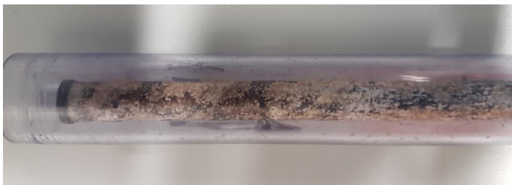
Abbildung 75: Outside-In Membran nach 48 Stunden Betrieb
