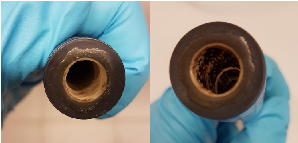
Abbildung 78: links:Scaling nach 51h Filtration (IO-3: Trinkwasser + DCF) rechts:Fouling nach 16h Filtration (IO 6: Kläranlagenablauf + DCF)
