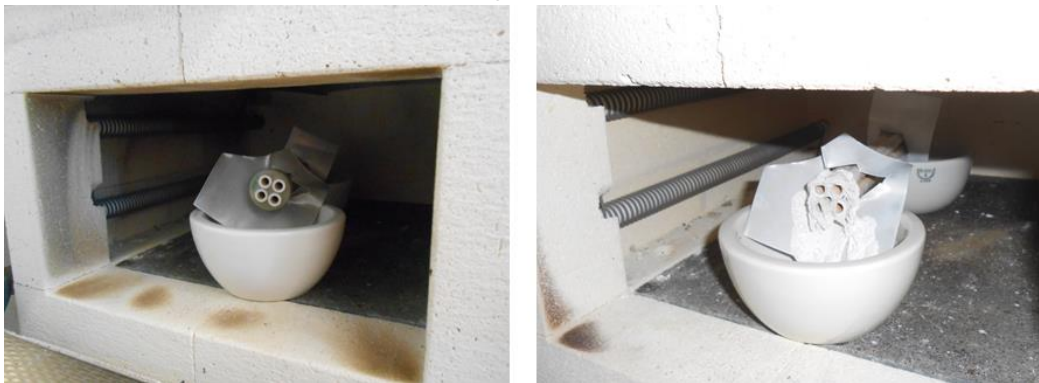
Abbildung 24: Thermische Behandlung des Keramikmembranmoduls im Muffelofen
