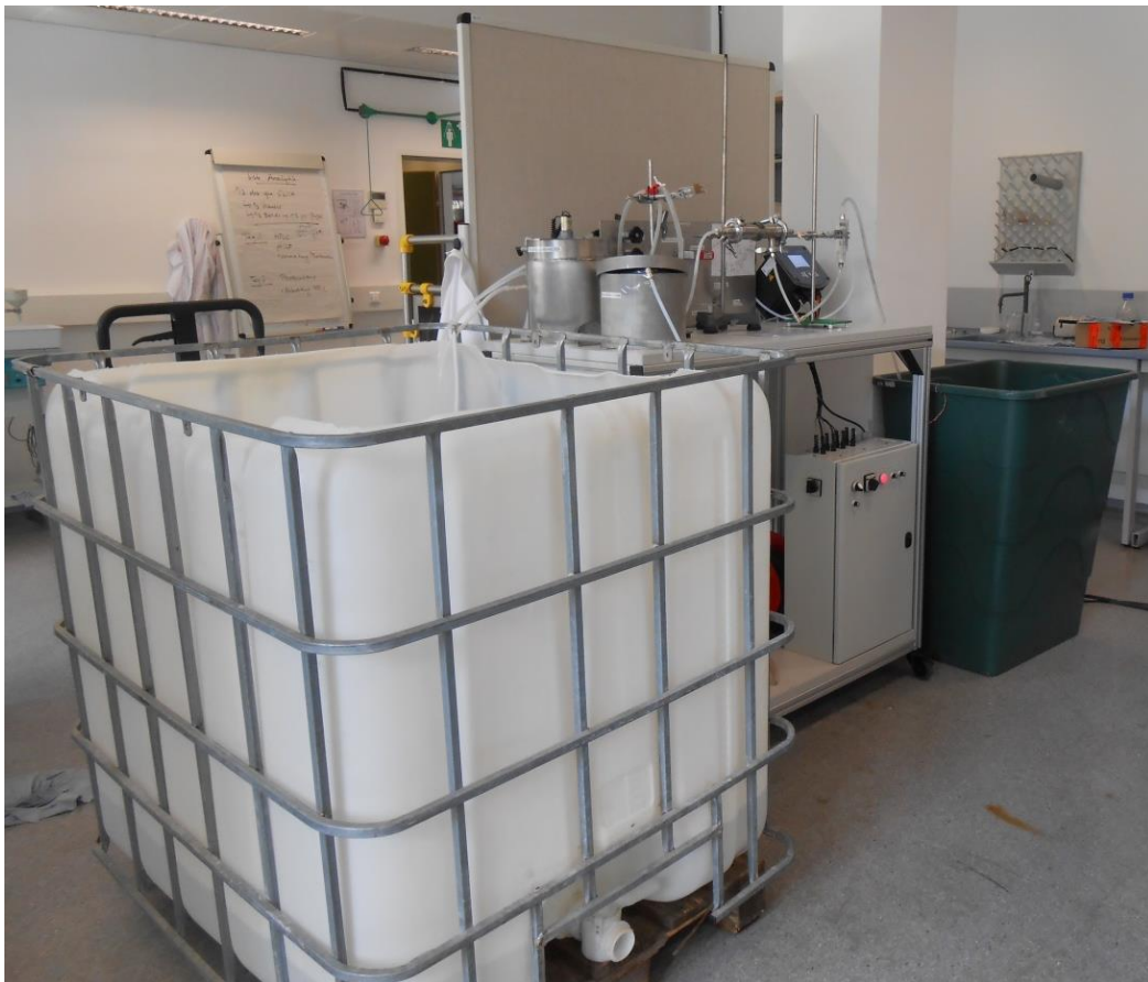
Abbildung 20: Versuchsaufbau für Langzeitversuche (LV) zur Charakterisierung der Rohrmodul-Adsorptions-Kombination
